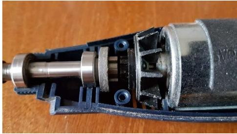
Le mécanisme sans jonction elle est en plastique et a fini en petits morceaux (nettoyage au pinceau)
